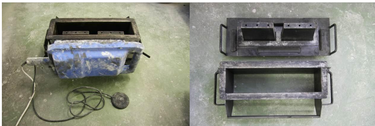
Figura 2.- Bloquera de vibrado portátil con alimentación mediante batería
